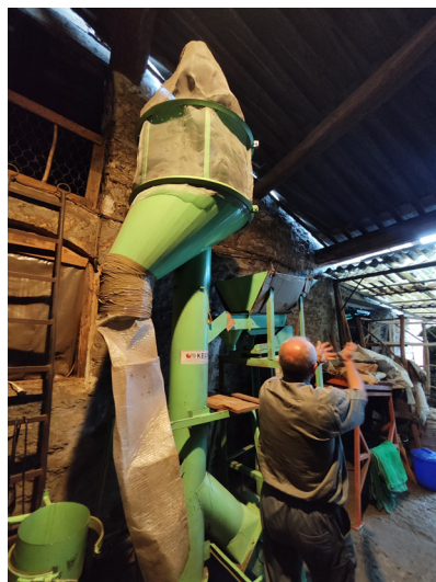
Images 5-10. Système de séchage et de conditionnement des feuilles de busserole. Source : CTFC
